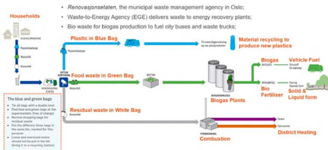
Obr. 20 - Systém pro nakládání s odpady za účelem vytvoření energie v Oslu (upraveno autorem)
