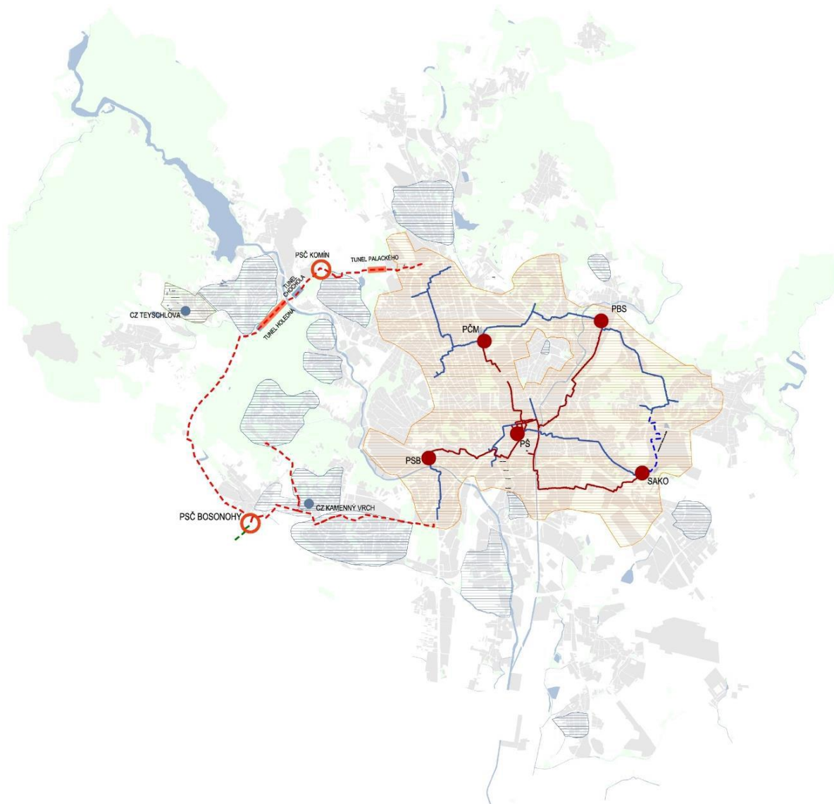
Obrázek 51: Záměry nových rozvodů tepla navazujících na TN EDU na území Brna
